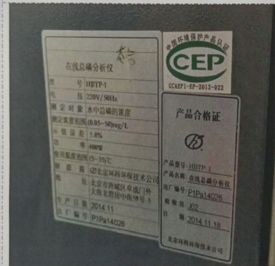
图 7: 总磷在线检测设备铭牌
